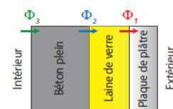
2. Le mode de transfert thermique mis en jeu est la conduction à travers les murs.
